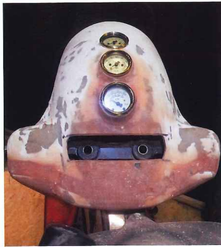
Ein kompletter Arbeitstag steckt in der Lampenmaske, modifiziert aus einem Teil von Rick's Motorcycle. Die Maske kompensiert jetzt den zusätzlichen Gabelwinkel und nimmt die Instrumente auf
