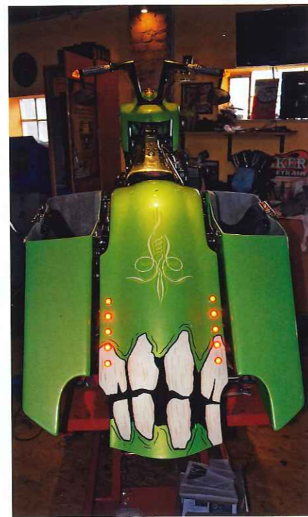
Die Arien Ness Down'n'Out-Komponenten ließen sich „bolt on“ montieren. Die eingepassten Micro-Lichter sind für den öffentlichen Straßenverkehr zugelassen
