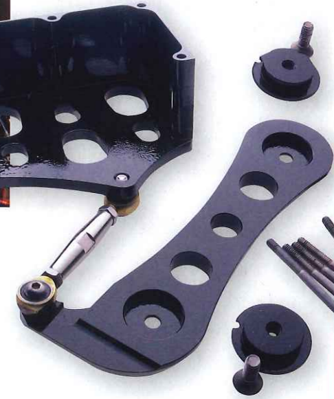
... und das hier fällt unter die Dinge, die man im eingebauten Zustand nie sieht: Ein Stabilisator für das Rahmenheckteil aus dem Katalog von Custom Chrome. Ohne diese zusätzlichen Stabilisatoren würde das betagte Fahrwerk keine 170 Sachen fahren
