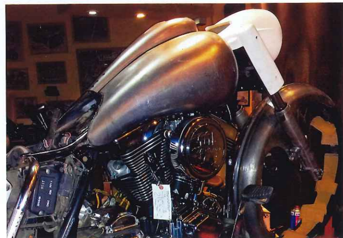
Ein kompletter Arbeitstag steckt in der Lampenmaske, modifiziert aus einem Teil von Rick's Motorcycle. Die Maske kompensiert jetzt den zusätzlichen Gabelwinkel und nimmt die Instrumente auf
