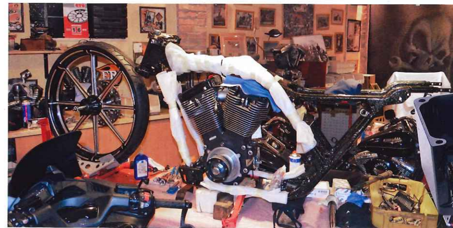
Jetzt ist der Rahmen lackiert und abgedeckt, damit weitere Schraubereien ihn nicht beschädigen. Achtet auf die riesige Dimension des 26"-Rades!
