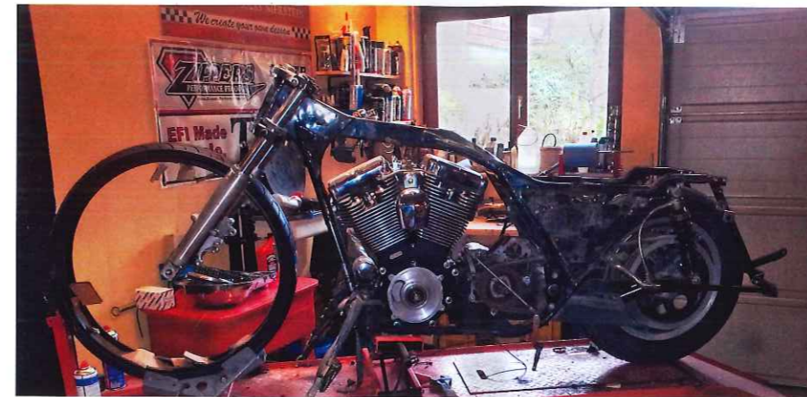
Die erste Einpassung des Motors wurde noch vor Zerlegung und Lackierung des Rahmens vorgenommen. Damit war sicher, dass genug Luft blieb, um den 125-Cubic-Incher zu montieren
