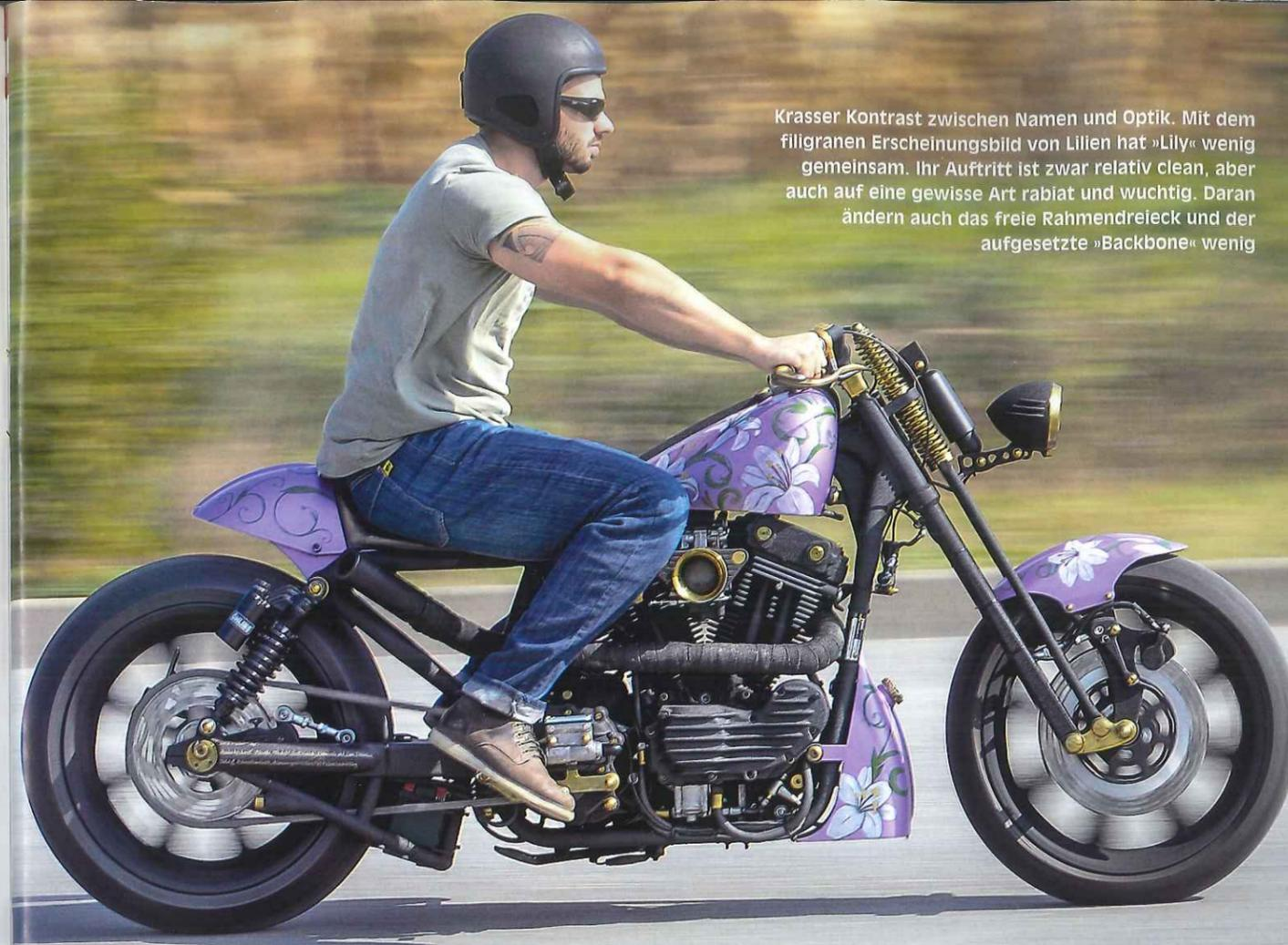
Der offene Trichter gibt ganz unpräzise Ansauggeräusche von sich, sieht aber gleichzeitig auch verdammt gut aus. Der Auspuff ist, gelinde gesagt, einfach nur gedämpftes Rohr. Und genauso hört er sich auch an: brutal. Blinker, die an den Bremsätteln befestigt sind, sieht man auch nicht alle Tage
